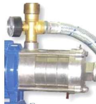
Figura 4: Sustitución del manómetro o presostato en una bomba multietapa
